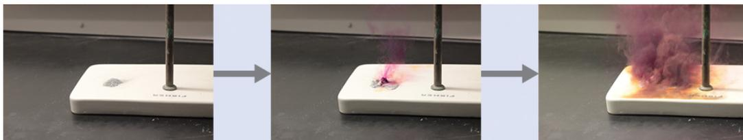
**Figura 4.10.** El aluminio y el yodo reaccionan para producir yoduro de aluminio. El calor de la reacción vaporiza parte del yodo sólido como vapor púrpura (crédito: modificación de obra por Mark Ott).
