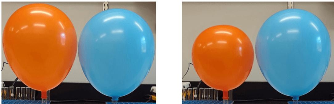
**Figura 8.29** La fotografía de la izquierda muestra dos globos inflados con diferentes gases, helio (naranja) y argón (azul). La fotografía del lado derecho muestra los globos aproximadamente 12 horas después de haberse llenado, momento en el cual el globo de helio se ha desinflado notablemente más que el globo con argón, debido a la mayor tasa de efusión del gas helio es más ligero (crédito: modificación del trabajo de Paul Flowers).
