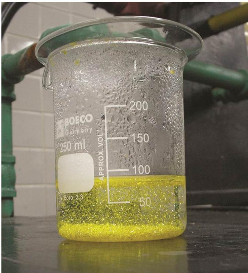
**Figura 4.4.** Se forma un precipitado de  $PbI_2$  cuando se mezclan soluciones que contienen  $Pb^{2+}$  e  $I^-$  (crédito: Der Kreole/Wikimedia Commons)
