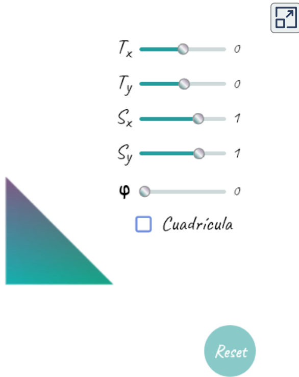
Figura 4.5. Transformaciones afin. Se aplica la matriz \mathbf{M} = \mathbf{T}(T_x, T_y)\mathbf{R}(\phi)\mathbf{S}(S_x, S_y) sobre cada vértice del triángulo.
