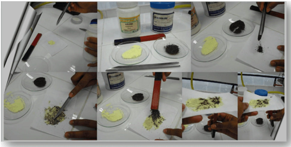
Figura 3.8. Magnetismo con imán álnico y limadura de hierro. (Crédito: elaboración propia)
