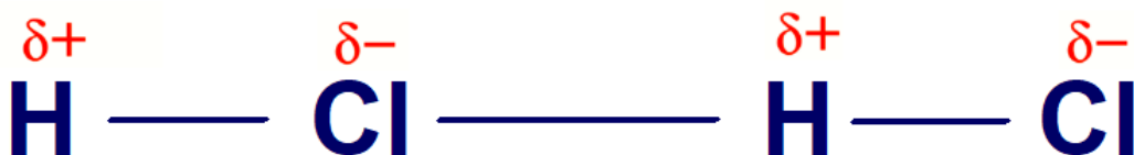
Figura 9.6. Interacción entre los dipolos eléctricos de las moléculas de cloruro de hidrógeno. Crédito a: http://commons.wikimedia.org/wiki/File:Dipole-dipole-interaction-in-HCl-2D.png . En Núñez González, Claudia. Libro de texto ciencias Química. http://upload.wikimedia.org/wikipedia/commons/6/62/LIBRO_TEXTO_IPP_QUIMICA.pdf
