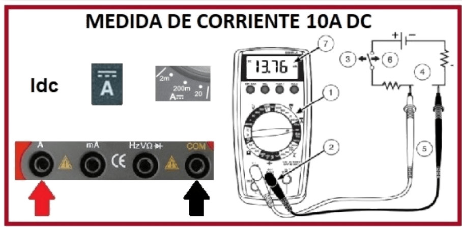
Figura 70. Medida de Corriente 10A DC
