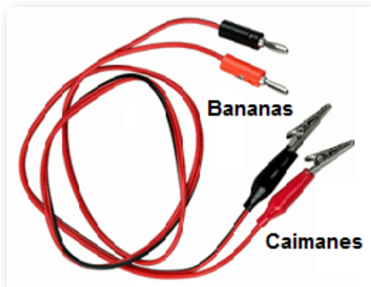
Figura 52. Cables de salida de la fuente de voltaje
