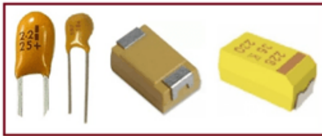
Figura 163. Condensador tipo tantalio
