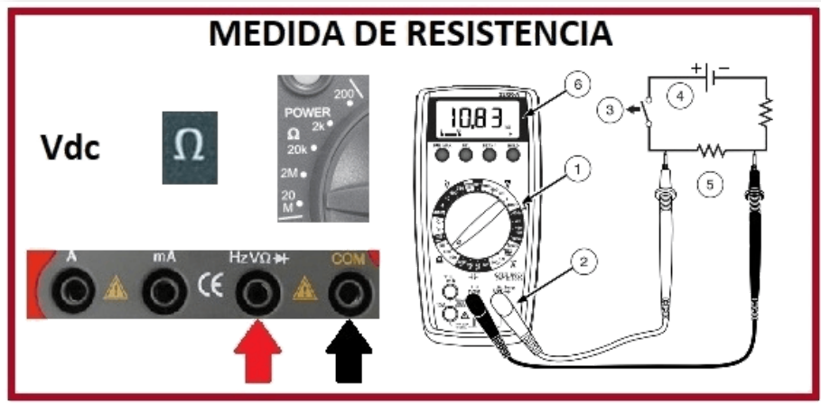
Figura 73. Medida de resistencia
