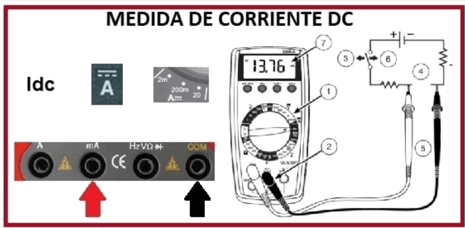
Figura 69. Medida de Corriente DC
