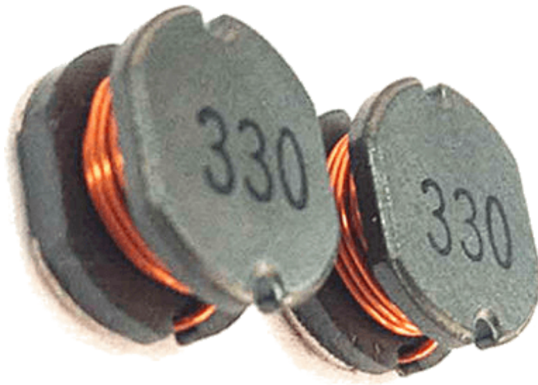
Figura 224. C digo num rico para los inductores (330 = 33\mu\text{H} )
