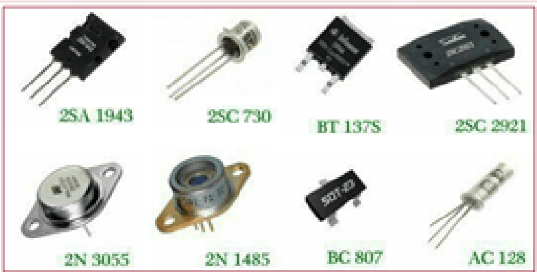
Figura 262. Diversos tipos de encapsulados y sus referencias propias
