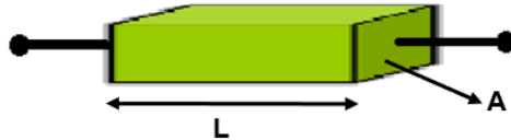
Figura 6. Resistencia eléctrica constructiva
