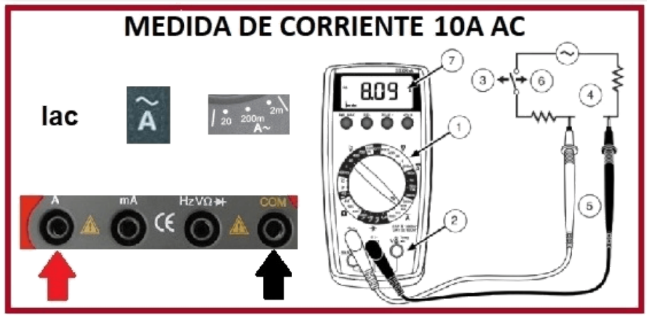
Figura 72. Medida de Corriente 10A AC
