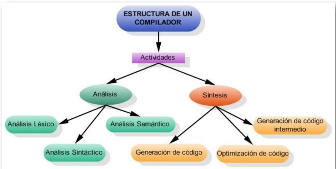
**Figura 4.2.** Estructura de un compilador.
