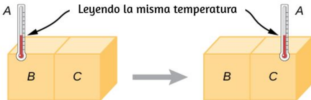
Figura 1.2. Si el termómetro A está en equilibrio térmico con el objeto B , y B está en equilibrio térmico con C , entonces A está en equilibrio térmico con C . Por lo tanto, la lectura en A permanece igual cuando A se mueve para entrar en contacto con C .
