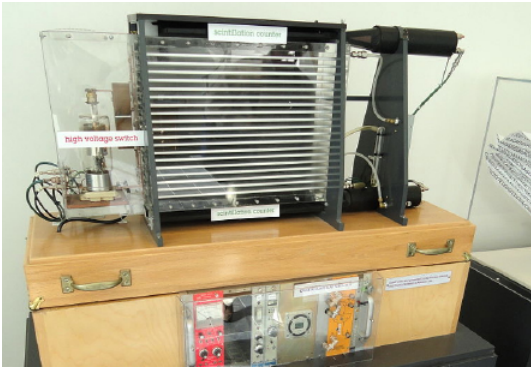
Figura 7.16. Una cámara de chispa se usa para rastrear las rutas de las partículas de alta energía. La ionización creada por las partículas a medida que pasan a través del gas entre las placas permite que salte una chispa. Las chispas son perpendiculares a las placas, siguiendo líneas de campo eléctrico entre ellas. La diferencia de potencial entre las placas adyacentes no es lo suficientemente alta para causar chispas sin la ionización producida por las partículas de los experimentos del acelerador (o rayos cósmicos). Esta forma de detector ahora es arcaica y ya no se usa excepto para fines de demostración (crédito b: modificación del trabajo por Jack Collins).
