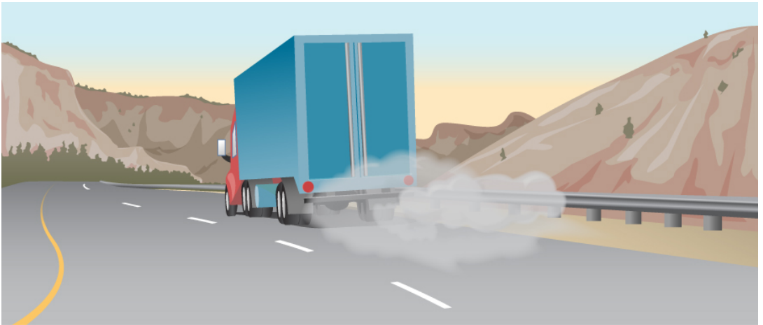
Figura 1.11. El humo de los frenos en un camión son evidencia visible del equivalente mecánico de calor.
