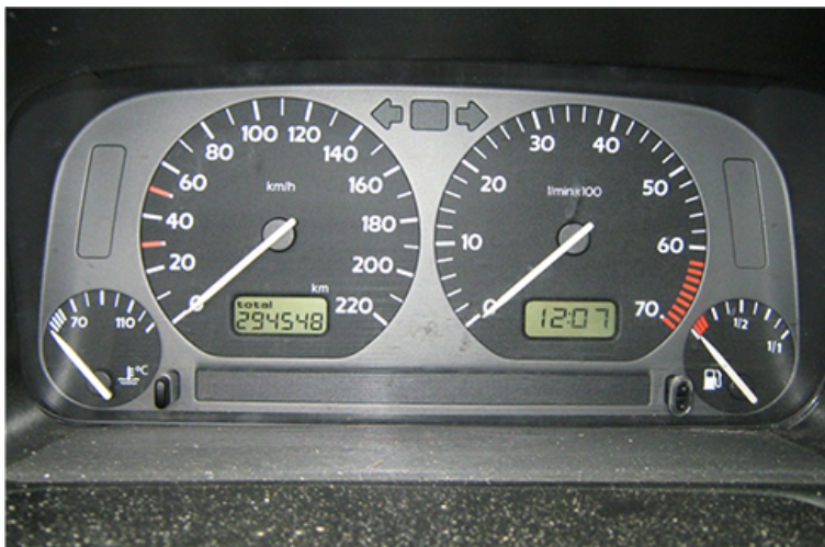
Figura 10.34. Los medidores de combustible y temperatura (extremo derecho y extremo izquierdo, respectivamente) en este Volkswagen 1996 son voltímetros que registran la salida de voltaje de las unidades "emisoras". Estas unidades son proporcionales a la cantidad de gasolina en el tanque y a la temperatura del motor (crédito: Christian Giersing).
