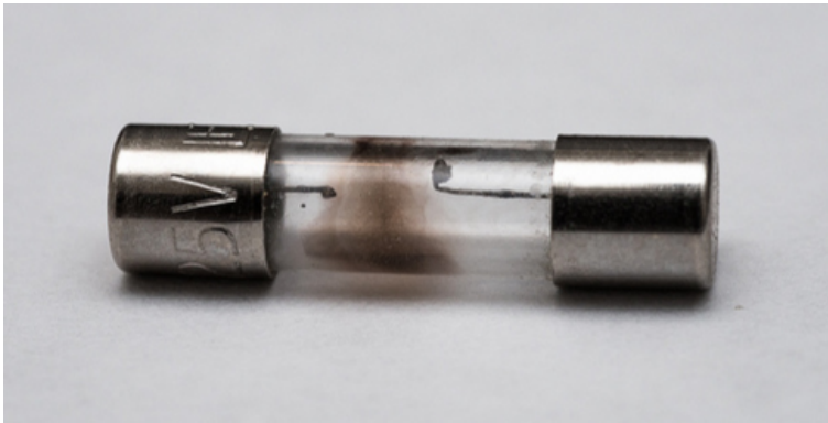
Figura 9.25. Un fusible consiste en un trozo de cable entre dos contactos. Cuando una corriente pasa a través del cable que es mayor que la corriente nominal, el cable se derrite, rompiendo la conexión. La imagen es un fusible "fundido" donde el cable se rompió protegiendo un circuito (crédito: modificación del trabajo por "Shardayyy" / Flickr).
