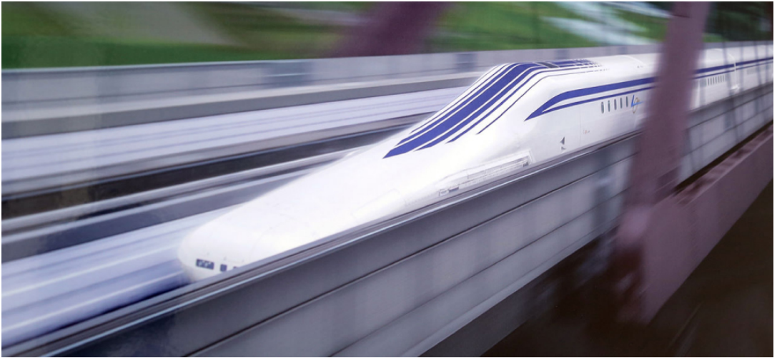
Figura 3.1. Un tren de levitas de Maglev (levitación magnética) de la serie JR Central LO que se somete a una prueba en la pista Yamanashi. El movimiento del tren de levitación magnética se puede describir utilizando la cinemática, el tema de este capítulo. (crédito: modificación del trabajo por "Maryland GovPics" / Flickr)
